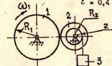
I.3. Определить угловое ускорение катка 2, катящегося без скольжения, если на блок 1 действует пара сил с моментом  $M = 0,6 \text{ Н}\cdot\text{м}$ . Каток 2 считать однородным цилиндром массой  $m = 4 \text{ кг}$  и радиусом  $\zeta = 0,5 \text{ м}$ .
