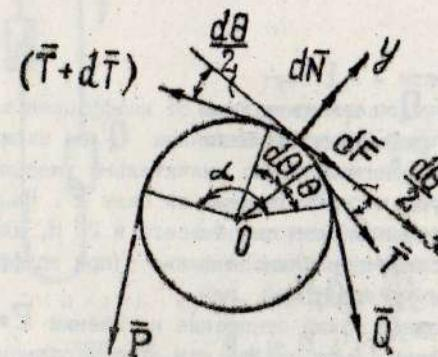
Рассмотрим равновесие элемента нити длиной  $dL = Rd\theta$ , где  $R$  - радиус шкива. Разность натяжений нити  $dT$  уравновешивается силой трения  $dF = f_0 dN$ , следовательно,  $dT = f_0 dN$ . Значение  $dN$  найдем из уравнения равновесия в проекции на ось. Учитывая, что синус малого угла равен самому углу, и пренебрегая малыми высшего порядка, будем иметь
