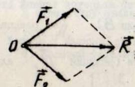
Не нарушая состояния твёрдого тела, две силы, приложенные к точке этого тела, можно заменить одной силой (их равнодействующей), которая по величине и направлению равна диагонали параллелограмма, построенного на этих силах. Равнодействующая этих сил  $\vec{R}$  является их геометрической суммой, т.е.
