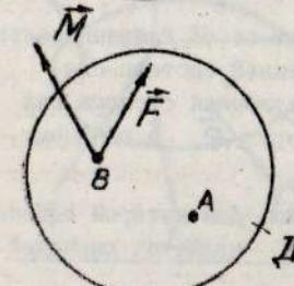
в точке  $A$ , и сила  $-\vec{F}$ , приложенная в точке  $B$ , образуют пару сил с вектором-моментом  $\vec{M}$ , равным вектору-моменту переносимой силы  $\vec{F}$  относительно точки  $B$ , т.е.
