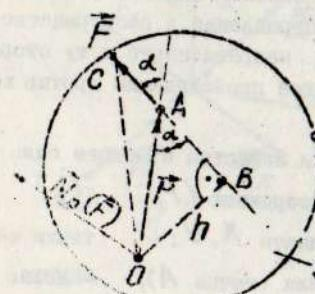
силы  $|\vec{F}|$  и длины плеча  $h$ , от положения плоскости поворота и направления поворота в этой плоскости.
