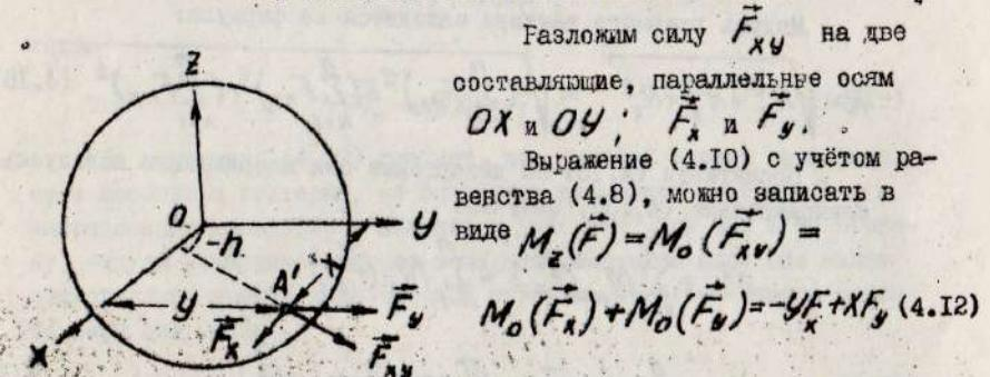
Разложим силу  $\vec{F}_{xy}$  на две составляющие, параллельные осям  $OX$  и  $OY$ :  $\vec{F}_x$  и  $\vec{F}_y$ .
