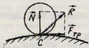
$\vec{R}$  неизвестно. При решении задач реакцию  $\vec{R}$  раскладывают на две составляющие: нормальную реакцию  $\vec{N}$  и силу трения  $\vec{F}_{tr}$ .
