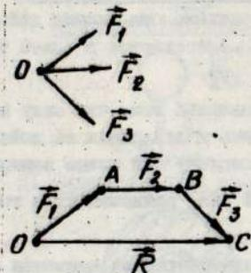
Условием равновесия сходящейся системы сил является замкнутость силового многоугольника, что эквивалентно равенству нулю равнодействующей:
