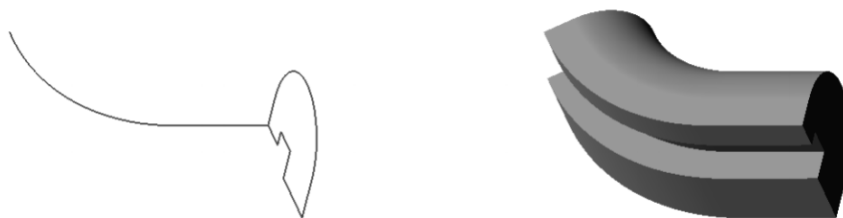
Рис. 2.7 - Кінематична операція протягування
