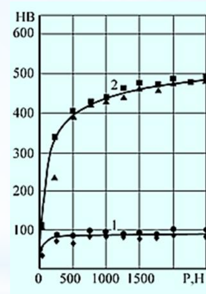
Рис. 10.3 – Залежність твердості HV від навантаження: 1 – армко-залізо і дюралюміній; 2 – високохромистий сплав і сталь 35
