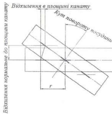
Рисунок 2 – Схема переміщень канатів в перерізі їх приєднання до посудини у випадку повороту посудини в горизонтальній площині
